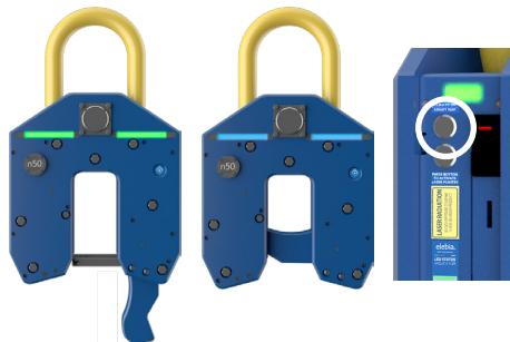
Im Modus "Always On" (Immer an) ist das Farbcodeschema der LED-Statusanzeige immer sichtbar. Blau – für geschlossen – und grün – für offen – sind 10 Sekunden lang kontinuierlich und folgen dann einem intermittierenden Muster, um die Batterie zu schonen. Aktivieren Sie diesen Modus, indem Sie den oberen Knopf neben dem Akku drücken.
