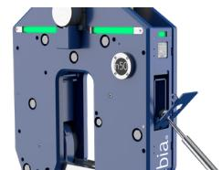
Stecken Sie das Ende bzw. die Spitze der Stange in den Schlitz der Abdeckung.
