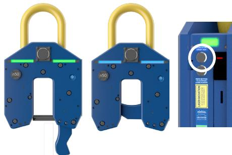
Con el modo "Always ON" (siempre encendido), el esquema del código de colores del indicador de estado LED siempre será visible. Azul – estado cerrado – y Verde – estado abierto – es continuo durante 10 segundos y luego toma un patrón intermitente para ahorrar batería. Activa este modo presionando el botón superior junto a la batería.
