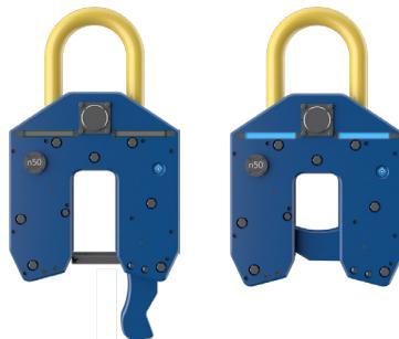
El modo "Smart Nap" reduce el consumo de batería al activar el esquema del código de colores del indicador de estado LED cuando el gancho comienza su movimiento de cierre. Hasta ese momento, el gancho de elevación NEO está en modo suspensión y su electrónica y la batería no están activas.
