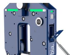
Tire hasta que la cubierta se abra y esperar hasta que los LED se vuelvan verdes.
