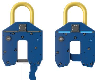
Der "Smart Nap"-Modus reduziert den Batterieverbrauch, indem er das Farbcodierungsschema der LEDs aktiviert, wenn der Haken des NEO mit dem Schließvorgang beginnt. Bis zu diesem Zeitpunkt befindet sich der Hebehaken im Schlafmodus und seine Elektronik und Batterie sind nicht aktiv.
